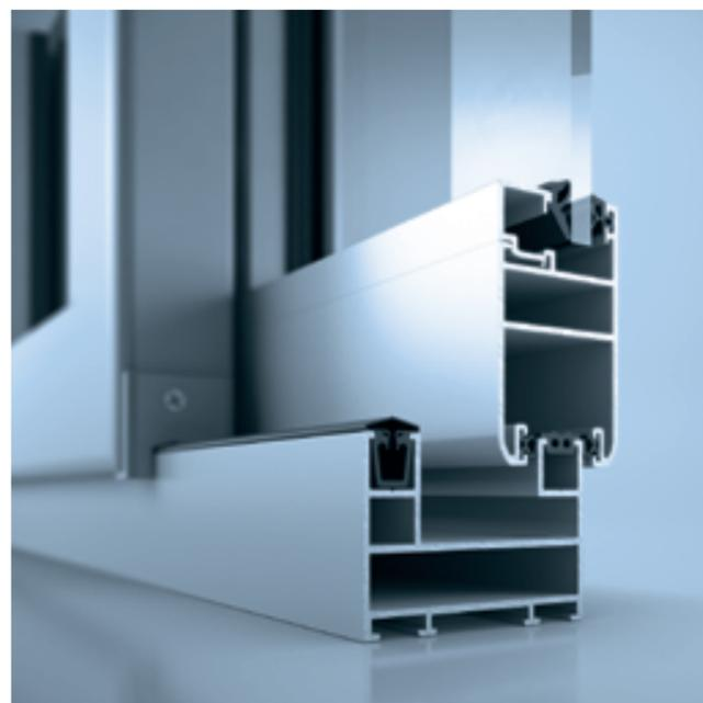
heroal S 50 C est la solution attractive pour les éléments et les portes coulissantes en intérieur et en extérieur. Les éléments coulissants 2 et 3 voies à 6 ouvrants mobiles possibles peuvent être réalisés avec des largeurs visibles étroites et offrent une protection efficace contre le vent et les intempéries. L'ouvrant et la zone labyrinthe sont équipés d'un système de joint qui a fait ses preuves et le rail en acier inoxydable assure un glissement sûr et durable.
