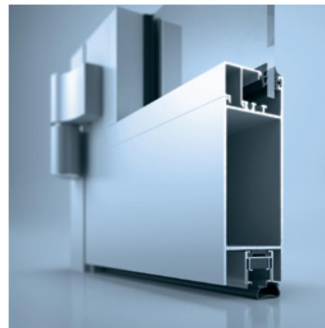
heroal D 50 C offre une grande variété de types d'ouverture avec des éléments de porte et de séparation attractifs et très fonctionnels ainsi que des systèmes de cloison de séparation qui sont principalement utilisés en intérieur. Le système de porte heroal est équipé d'un système de joint rétractable rotatif qui a fait ses preuves pour les profilés de dormant et d'ouvrant. La vue extérieure intégrée offre de nombreuses possibilités de personnalisation.
