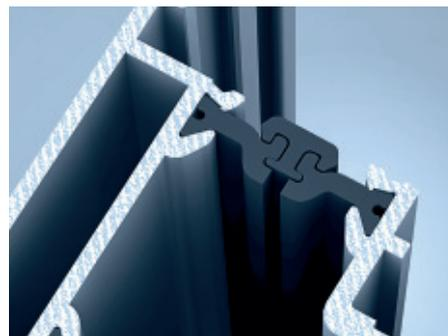
**Fase 1:** per evitare il forte influsso della differenza di temperatura sul funzionamento e sull'aspetto degli elementi del sistema alzante-scorrevole, si utilizza l'assemblaggio anti-deformante brevettato heroal. Questo sistema protegge il profilo da forze di spinta dannose. Questo assemblaggio consiste di un telaio isolante arrotolato fisso e una molla a innesto.
