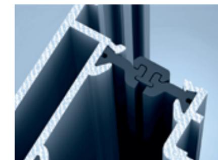
**Schritt 3:** Die Einschubfedern werden wieder eingesetzt. Der Profilverbund bleibt teilweise intakt und auftretende Schubkräfte können sich nicht auf das Getriebe und den Schließzylinder übertragen. Im Bereich des getrennten Verbunds verhält sich das Profil durch die Einschubfeder bei Querkzugkräften, die zum Beispiel bei einem Einbruchversuch auftreten, wie ein Profil mit konventionellem Verbund.
