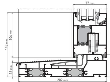
heroal S 77 SL, Hebe-Schiebeflügel, Schnittdarstellung
